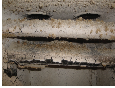
Şekil 2. Budama peletleri yanma testleri sırasında kül ile ilgili sorunlar gözlemlendi. Soldan sağa ve yukarıdan aşağıya doğru: otomatik kül boşaltma olmaması durumunda soba ızgarasında kül birikimi; soba ısı eşanjörü yüzeylerinde kül birikmesi; soba görüş penceresinde kül birikmesi; bir kazanın ızgarası üzerinde kül birikmesi (otomatik kül giderme olmayan sabit ızgara).
