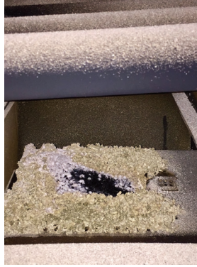
Şekil 2. Budama peletleri yanma testleri sırasında kül ile ilgili sorunlar gözlemlendi. Soldan sağa ve yukarıdan aşağıya doğru: otomatik kül boşaltma olmaması durumunda soba ızgarasında kül birikimi; soba ısı eşanjörü yüzeylerinde kül birikmesi; soba görüş penceresinde kül birikmesi; bir kazanın ızgarası üzerinde kül birikmesi (otomatik kül giderme olmayan sabit ızgara).
