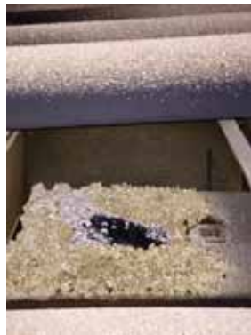
Slika 2. Problemi povezani s pepelom uočeni tijekom testova sagorijevanja peleta od rezidbe. S lijeva na desno i od vrha prema dolje: akumulacija pepela na rešetki peći bez automatskog uklanjanja; taloženje pepela na površinama izmjenjivača topline peći; taloženje pepela na prozorčiču štednjaka; taloženje pepela na rešetki kotla (fiksna rešetka bez automatskog uklanjanja).
