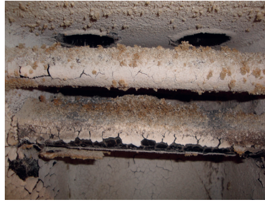
Slika 2. S pepelom povezane težave, opažene med preskusom zgorevanja peletov iz vinogradiškega in oljčnega odreza. Od leve proti desni in od zgoraj navzdol: nabiranje pepela na rešetki peči brez samodejnega odstranjevanja pepela; nabiranje pepela na površinah toplotnega izmenjevalca v peči; nabiranje pepela na vizirnem oknu v peči; nabiranje pepela na rešetki kotla (fiksna rešetka brez samodejnega odstranjevanja pepela)
