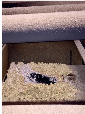
Slika 2. S pepelom povezane težave, opažene med preskusom zgorevanja peletov iz vinogradiškega in oljčnega odreza. Od leve proti desni in od zgoraj navzdol: nabiranje pepela na rešetki peči brez samodejnega odstranjevanja pepela; nabiranje pepela na površinah toplotnega izmenjevalca v peči; nabiranje pepela na vizirnem oknu v peči; nabiranje pepela na rešetki kotla (fiksna rešetka brez samodejnega odstranjevanja pepela)
